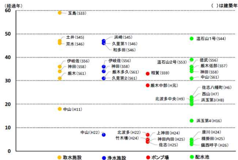
※平成29年8月「唐津市水道事業経営戦略」より 図表5 主な水道施設の整備状況
