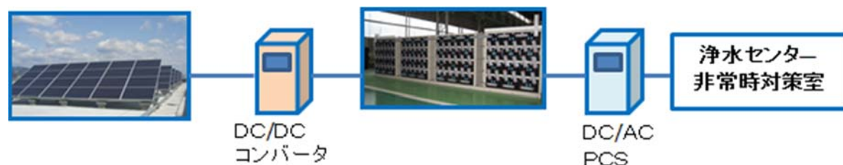
図-1. 13 太陽光発電と蓄電池を組み合わせた非常用電力供給システム
