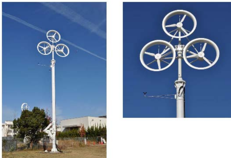
図-1. 2 風レンズ風車 (9 kW)
