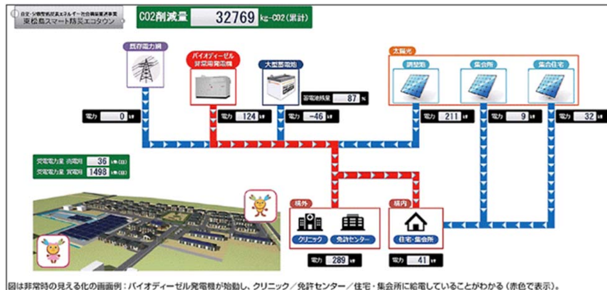
図は非常時の見える化の画面例：バイオディーゼル発電機が始動し、クリニック/免許センター/住宅・集会所に給電していることがわかる（赤色で表示）。 出所 「再エネを地域で活かし使う～東松島市の挑戦～」東松島市復興政策部復興政策課／一般社団法人東松島みらいとし機構、2016.11.21
