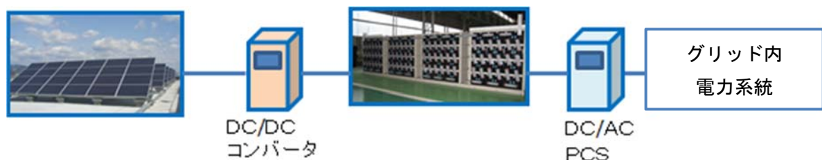
図－1．25 太陽光発電と蓄電池を組み合わせた非常用電力供給システム
