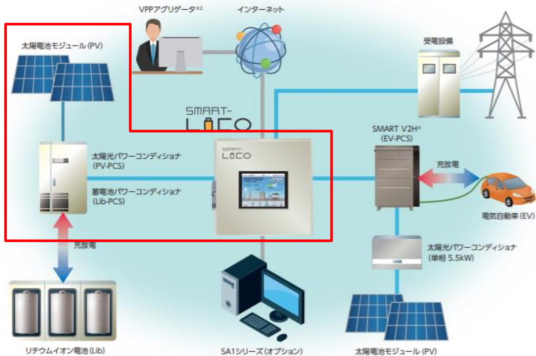
図 3.7 「発電設備逆潮流防止制御」及び「発電設備優先制御」の対象範囲（赤枠）
