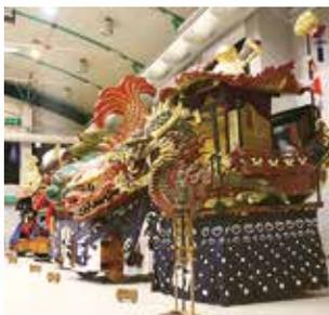
臨時展示場は、14台の曳山の重みに耐えられるように床を厚さ10cmのコンクリート土間打ちにし、また、曳山が傷まないよう、遮光カーテンや空調が直接あたらないようにする吹き出し口の整備などに使われています。
