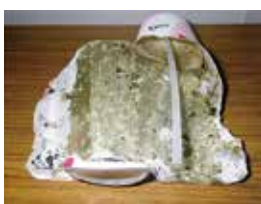
▲破裂したエアゾール式消火具
