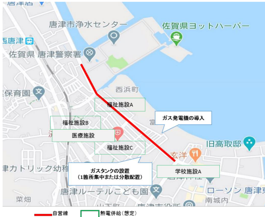
図 3.3 コジェネレーションシステムの導入コンセプト
