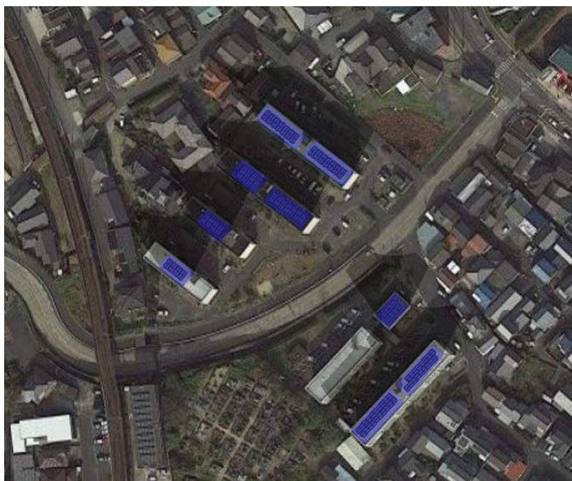
写真 市営住宅 B、C（自営線南側）の太陽光発電導入ポテンシャル（計 90kW）
