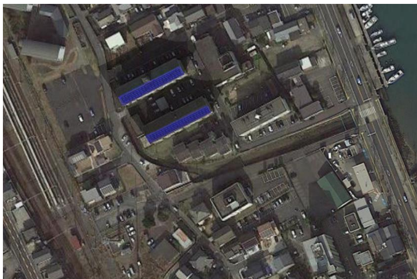
写真 市営住宅 A（自営線北側）の太陽光発電導入ポテンシャル（計 50kW）
