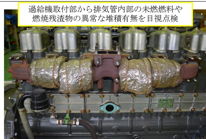
図2 排気管内部目視点検
