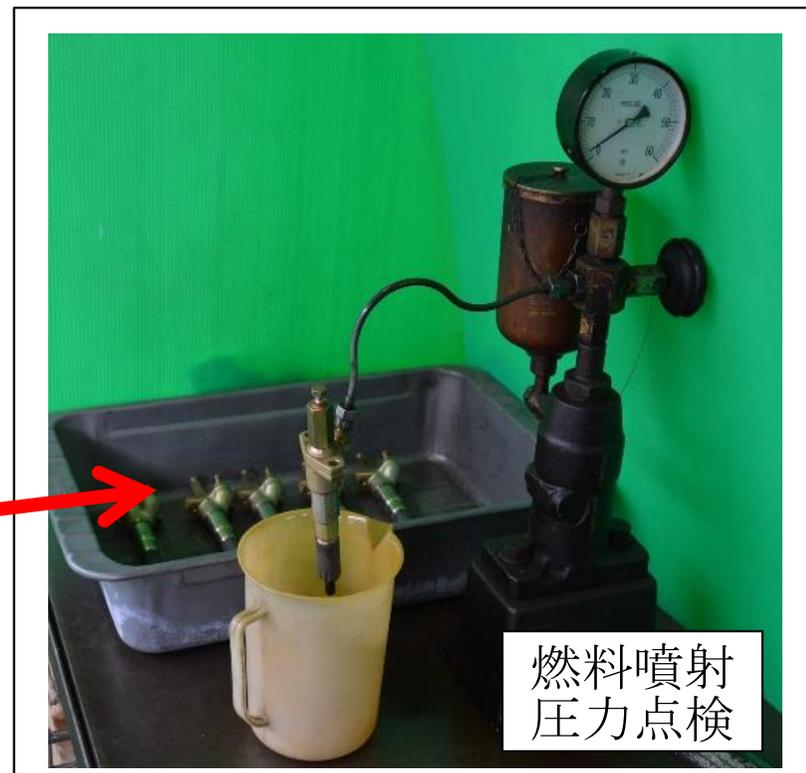
・燃料噴射弁を取り外し、作動させて、噴射状態と噴射圧力を確認する。
